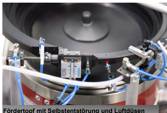
Fördertopf mit Selbstentstörung und Luftdüsen
