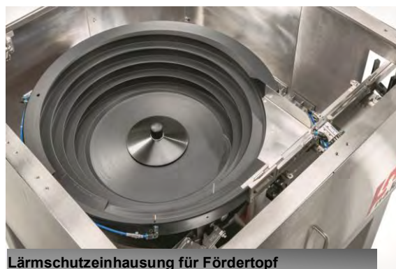
Lärmschutzeinhausung für Fördertopf
