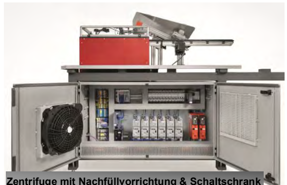
Zentrifuge mit Nachfüllvorrichtung & Schaltschrank
