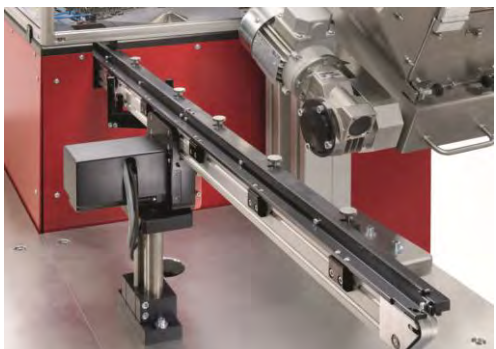
Förderband als Transportstrecke für Zentrifuge
